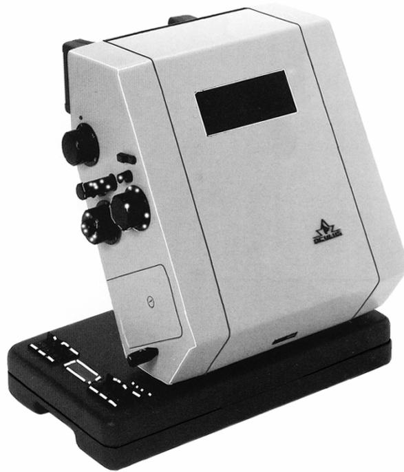
Fig. 1. Mesoptómetro o Nictómetro.
