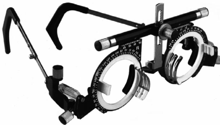
Fig. 1. Gafa o montura de pruebas.
