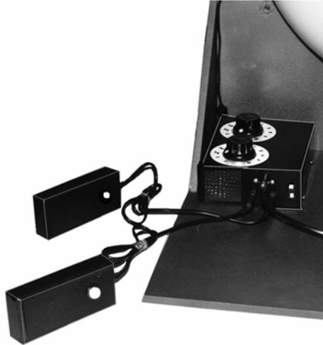
**Fig. 11.** Unidad de regulación de la intensidad luminosa en el interior de la cúpula, junto con la unidad que también regula la intensidad luminosa del estímulo, así como los dos pulsadores, uno para la persona explorada que indica mediante el mismo cuando visualiza el estímulo, y el otro sirve para que el médico explorador active el estímulo luminoso.
